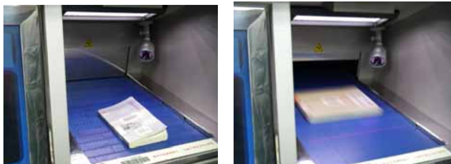
【圖四，紅外線掃描圖書成功後，書很快即送入分類機內；還書機可接受圖書的大小--其寬度不超過輸送機寬，高度不超過書進入分類機的匣門(約 15cm)】
