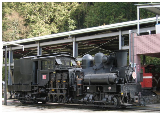
圖 40 美國 Shay 式 26 噸蒸汽火車頭 （資料來源：維基百科）
